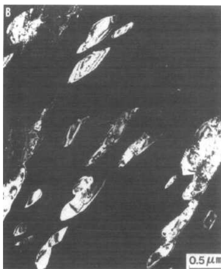
Figura 2.20: Morfologia da austenita revertida (partículas brancas) no aço 13-8 envelhecido a 600°C. [11]
