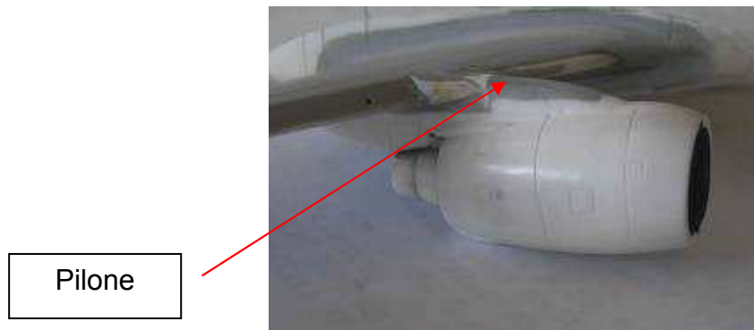
Figura 2.5: Pilone. Os parafusos que unem o pilone à asa são de aço 13-8.
