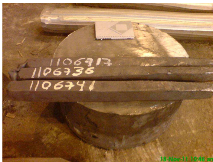
Figura 3.2: Barras forjadas de PH13-8Mo (Qd. 80,00 mm)
