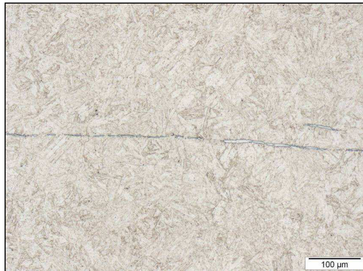
Figura 4.4: Ferrita delta (fase alongada e branca) na matriz martensítica do aço N4534QA envelhecido a 538°C. 200X. Villela.
