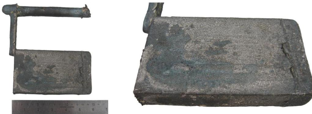
Figura 4.1 Lingote bruto de fusão. Observa-se o canal de alimentação ainda conectado ao lingote e a qualidade do acabamento superficial.
