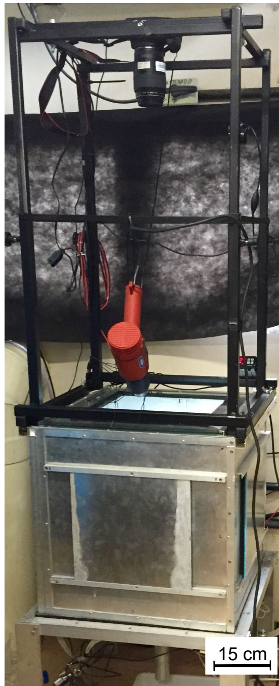
Figura 3.22 Fotografia da câmara térmica mostrando o posicionamento da câmera digital para a captura das imagens durante o ensaio.
