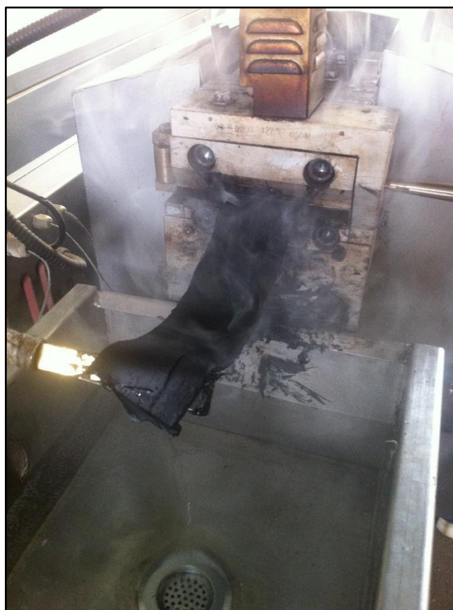
Figura 4.10 Material desvulcanizado saindo do cabeçote da ERDCI. Corrida 9: C2-3, 1 phr de enxofre, 350 rpm, 270°C, 10%(m/m) de EVA.
