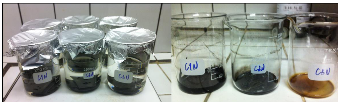
Figura 4.12 Método de extração da fração solúvel (FS). Extração em andamento à esquerda e fração solúvel obtida nos béqueres com a evaporação do solvente à direita. CXN representam os compostos não vulcanizados
