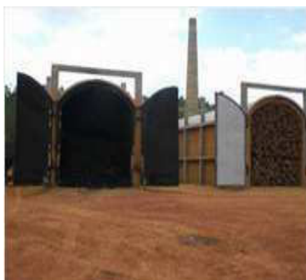
Fonte: Adaptado de [31,43]. (a) Forno colmeia com câmara externa
