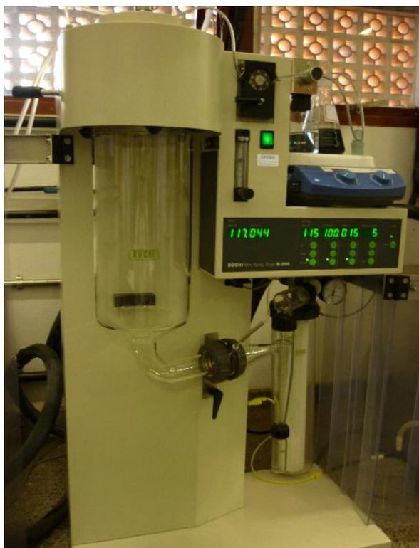
Figura 3.4 Spray Dryer utilizado nos experimentos de obtenção de compósitos Pani/NaAlH<sub>4</sub>.
