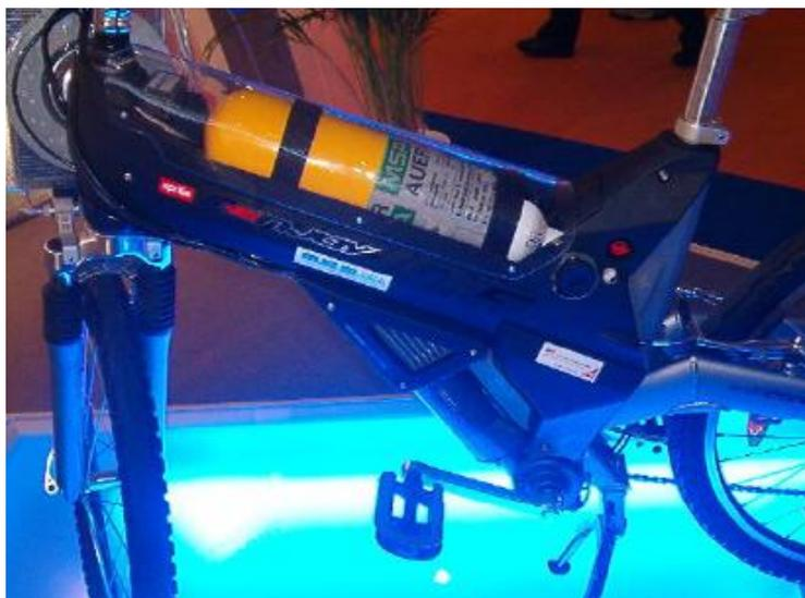
Figura 2.2 Fotografia de um depósito de armazenamento do hidrogênio sob a forma comprimida aplicado numa bicicleta elétrica. Fotografia tirada na Feira de Hannover em Abril de 2003 [1].
