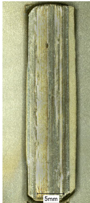
Figura 4.8 – Placa obtida por fundição por sucção após o tratamento de refusão superficial a LASER com potência de 300 W, velocidade de varredura de 100 mm/s e sobreposição de 50%.
