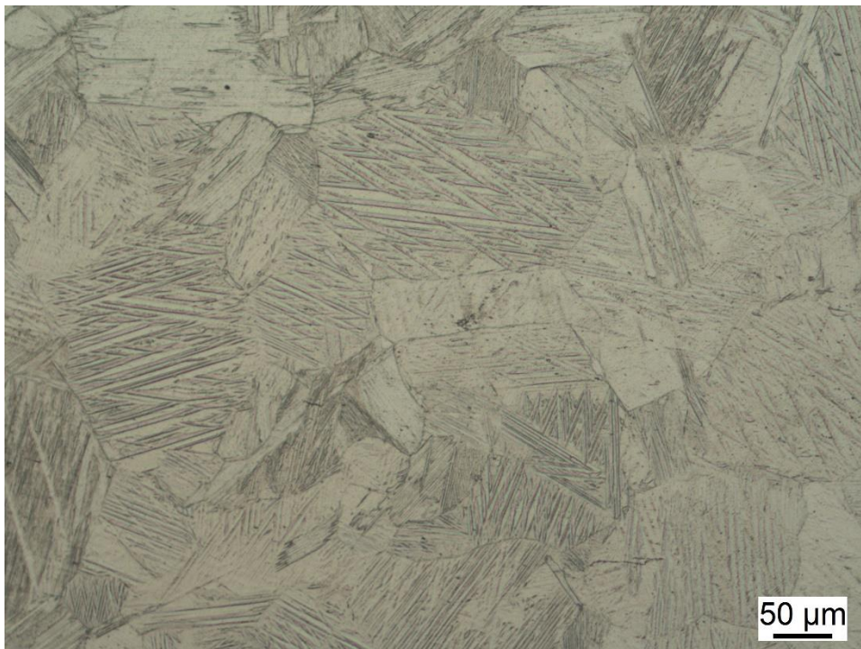
Figura 5.5 - Imagem de MO da seção longitudinal da amostra PLT_untreated. Grãos alongados da martensita \beta'_1 com morfologia em zig-zag podem ser observados.
