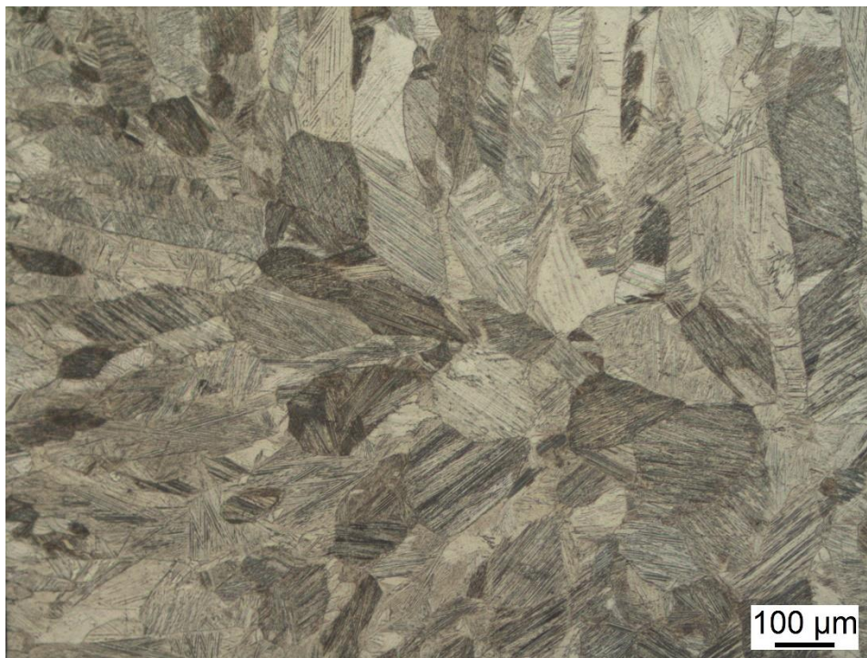
Figura 5.4 - Imagem de MO da seção transversal da amostra PLT_untreated. Grãos alongados da martensita \beta'_1 com morfologia em zig-zag podem ser observados.
