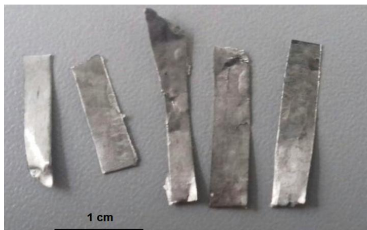
Figura 4.19: Tiras cortadas da liga Mg - 8%p. Zr laminada a frio, advindas do pó.
