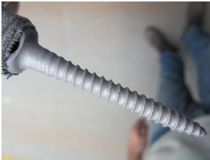
Figura 3.8: Parafuso após o processo de sand blasting.
