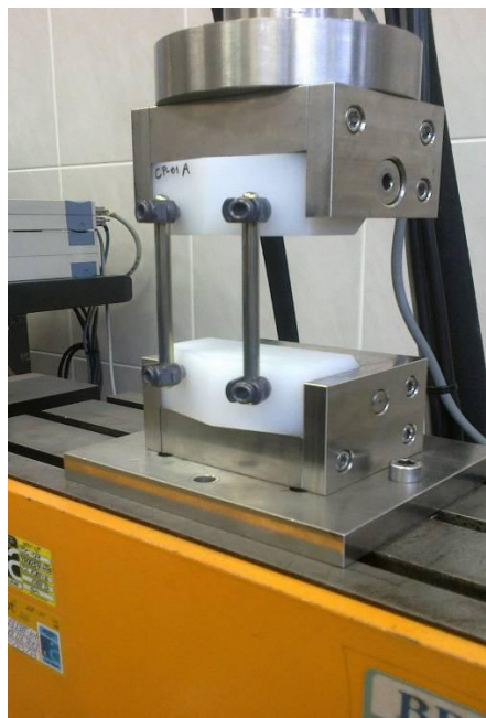
Figura 4.16: Disposição do Corpo de prova na máquina EE-01.
