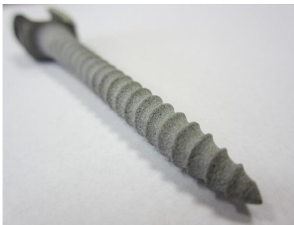
Figura 3.9: Produto Aspergido por Flame Spray .
