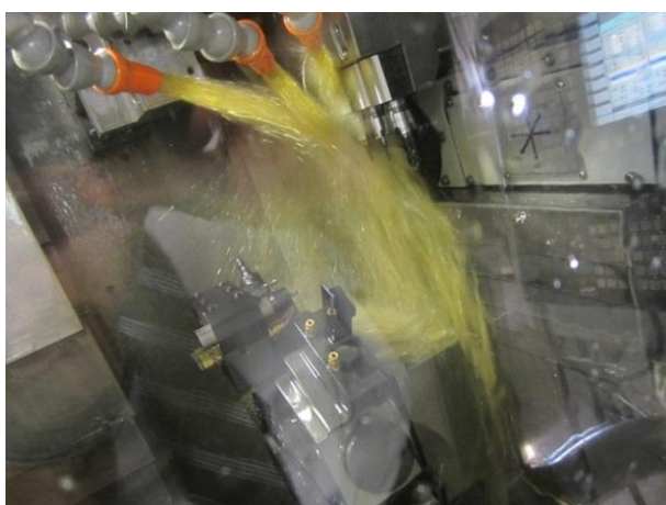
Figura 3.3: Processo de Usinagem dos Parafusos Pediculares.
