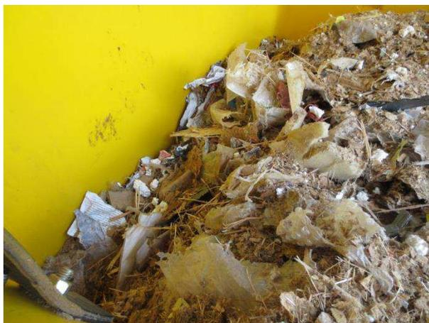
Figura 3. Materiais retirados na limpeza do resíduo de construção civil. Fonte: AUTOR.
