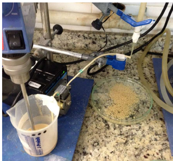
Figura 3.2 – Sistema utilizado na etapa de co-imobilização de enzimas e levedura em gel de alginato de cálcio
