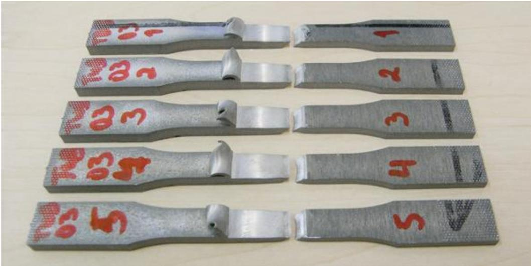
Figura 5.16 CPs da Amostra 03, após realização dos ensaios.
