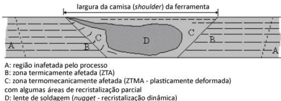
Figura 3.11 Microestrutura típica de uma junta soldada por FSW [19].
