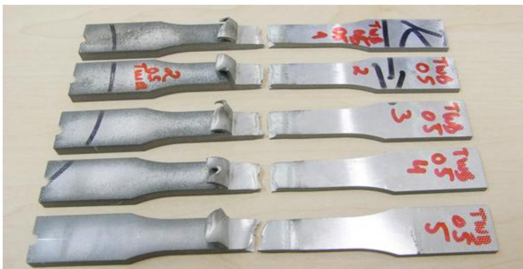
Figura 5.20 CPs da Amostra 05, após realização dos ensaios.
