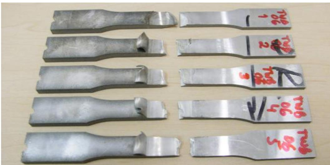
Figura 5.22 CPs da Amostra 06, após realização dos ensaios.
