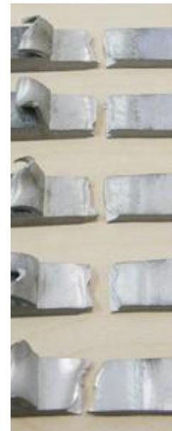
Figura 5.25 Relação observada entre os aspectos macrográficos das Amostras soldadas e as fraturas dos CPs ensaiados em tração.
