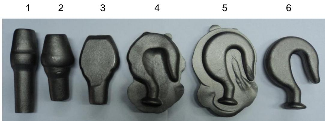
Figura 3.4 Peça conformada após os estágios de forjamento 1-6 (da esquerda para a direita): 1-2 Recalque; 3 Achatamento; 4-5 Forjamento em matriz; 6 Produto final após remoção da rebarba.
