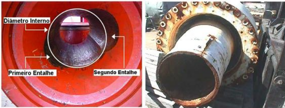
Figura 9 - Formação de entalhes e consequente falha de equipamentos usados na perfuração de poços de exploração de petróleo[15].
