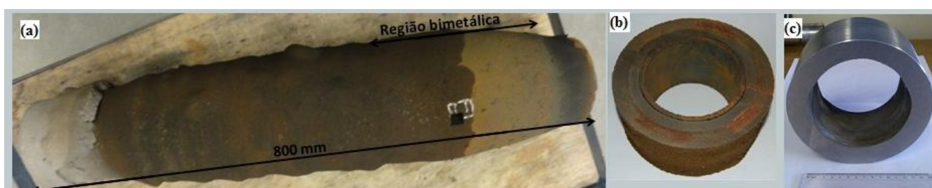
Figura 24 - Tubo bi-metálico conformado por spray.
