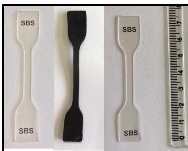
Figura 3.4 Corpos de prova empregados nos testes de tração uniaxial.
