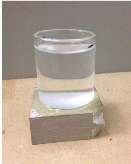
Figura 3.3 Corpo de prova preparado para os ensaios eletroquímicos.
