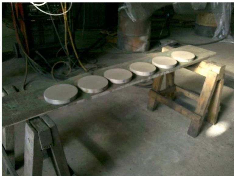
Figura 3.1. Discos de alumínio provenientes de um tarugo utilizado para extrusão.
