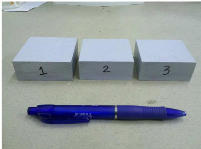
Figura 3.2. Corpos de prova cortados com 60 x 60 mm, para ensaios de corrosão e caracterização microestrutural.
