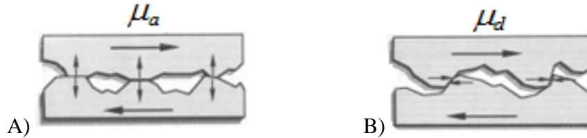
Figura 15.: A) Componente de adesão \mu_a e o B) Componente de deformação \mu_d .
