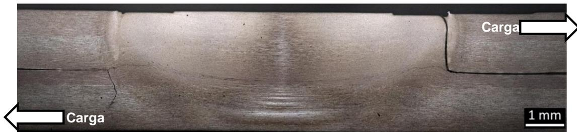
Figura 5.38 - Macrografia da seção transversal de um corpo de prova testado em fadiga antes da fratura total.
