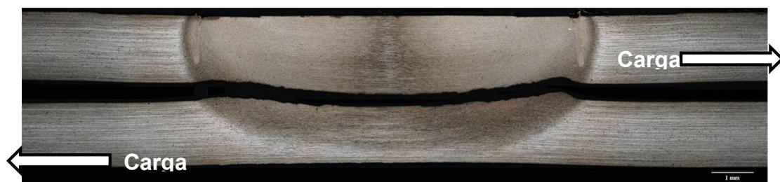
Figura 5.29 - Seção transversal de uma solda fraturada através do botão de solda, indicando a propagação da trinca através da linha de união.
