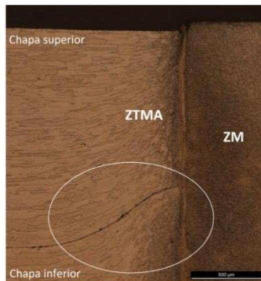
Figura 3.5 - Região do elemento cunha numa solda FSpW de alumínio [67].
