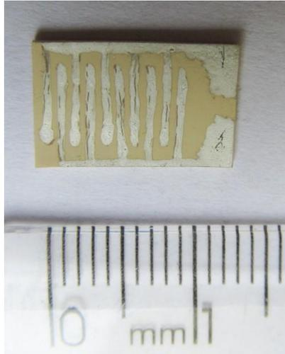
Figura 4.22 – Foto do elemento sensível com eletrodo pintado.
