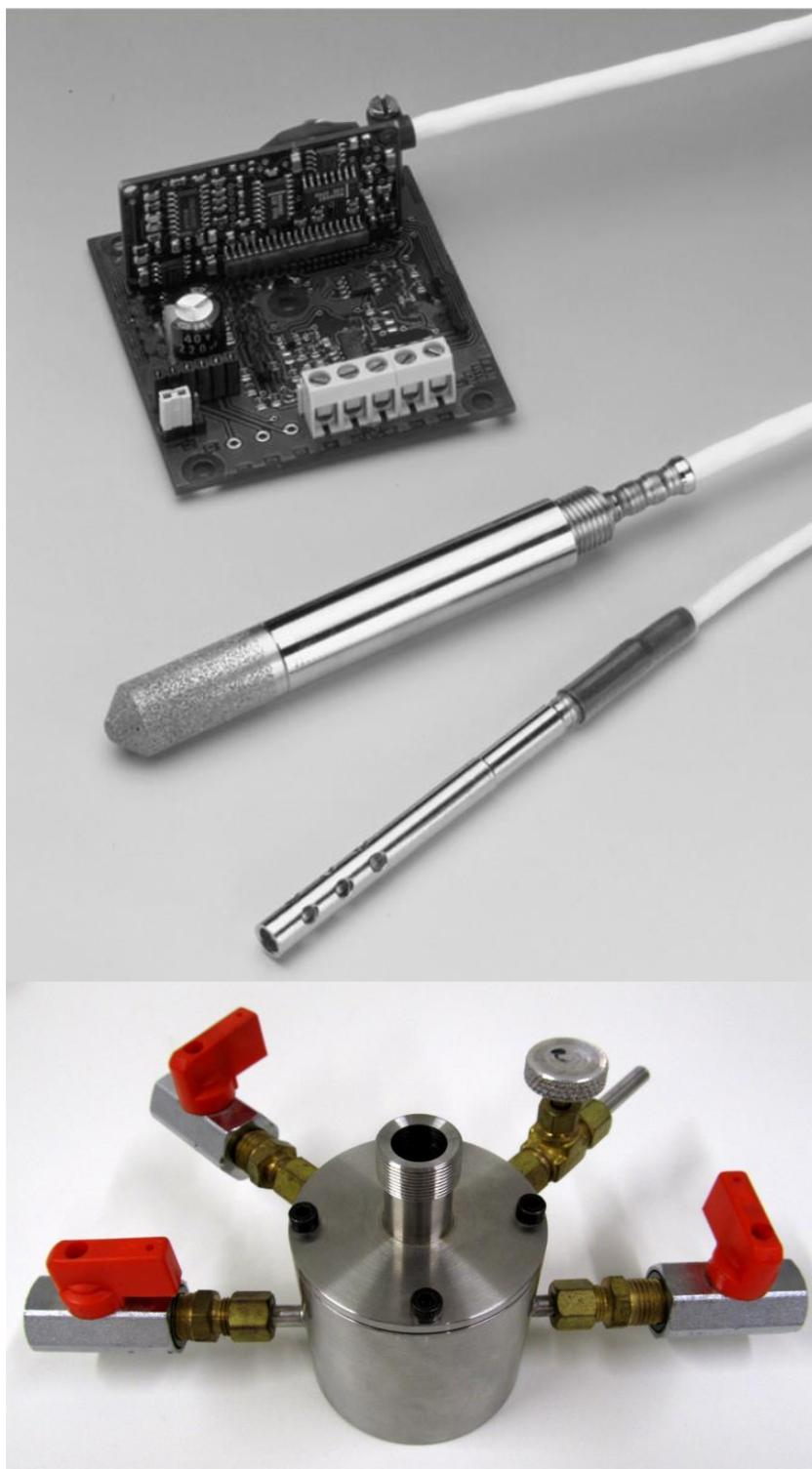
Figura 3.10 – Foto do sensor de referência (Vaisala HM213), acima, e a câmara onde é inserido, abaixo.
