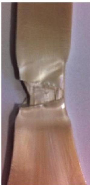
Figura 5.34 Corpo de prova da blenda *in situ*, ilustrando o comportamento de todas as blendas estudadas. A região do pescoço deforma de maneira não uniforme, apresentando um aspecto de desfibrilação
