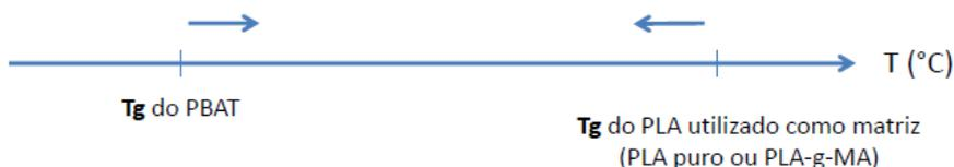
Figura 5.27 Esquema dos deslocamentos das Tg's referentes ao PLA utilizado como matriz nas blendas e do PBAT
