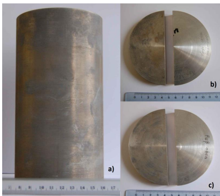
Figura 4.2 a) Cilindro após tratamento, b) corte da região superior, parte da esquerda foi homogeneizada e a direita está como depositada e c) corte da região inferior, parte esquerda homogeneizada e a direita como depositada.
