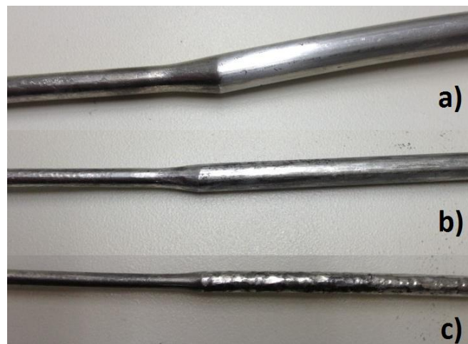
Figura 4.4 Etapas de redução de diâmetro por forjamento rotativo, sendo a) de 8,0 a 5,7 mm, b) de 5,7 a 4,0 mm e c) de 4,0 a 2,7 mm.
