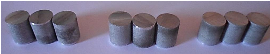
Figura 4.10 Corpos de prova do ensaio de compressão a quente do material homogeneizado antes do ensaio.
