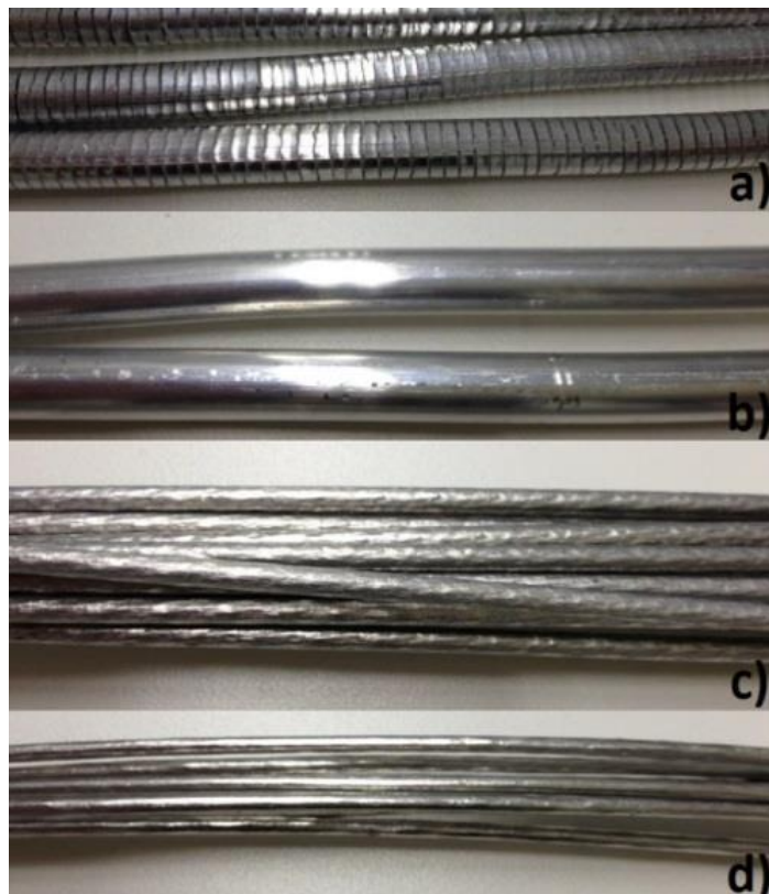
Figura 4.5 Barras obtidas pelos processos de extrusão e forjamento rotativo: a) barra de 8,0 mm obtida por extrusão a 450°C, b) barra de 8,0 mm obtida por extrusão a 420°C, c) barra de 2,7 mm obtida a partir da barra extrudada de 8,0 mm por forjamento rotativo e d) fio de 2,0 mm obtido por forjamento rotativo.
