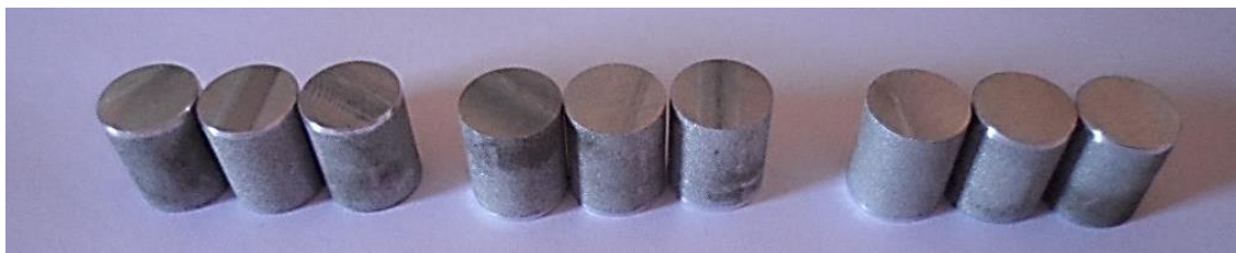
Figura 4.9 Corpos de prova do ensaio de compressão a quente do material não homogeneizado antes do ensaio.
