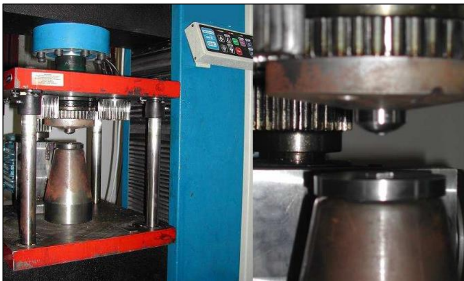
Figura 4.2. Máquina universal de testes EMIC e detalhe do punção utilizado.
