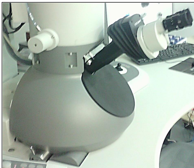
Figura 4.10. Detalhe da câmera acoplada no lugar da binocular do MET.
