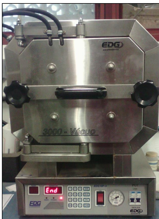
Figura 4.3. Forno resistivo a vácuo que trabalha com atmosfera controlada, utilizado para os tratamentos térmicos das amostras iniciais.
