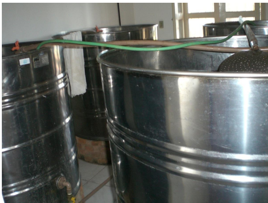
Figura 7. Dornas de fermentação utilizadas para a produção de cachaça.
