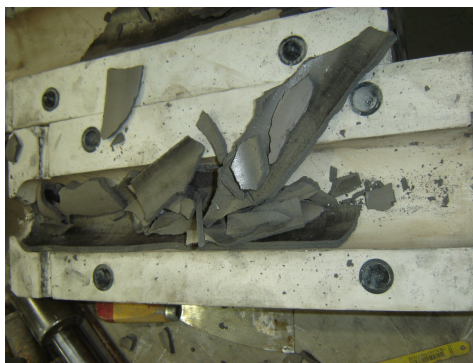
Figura 3.3: Dificuldade na extração do molde de gesso.
