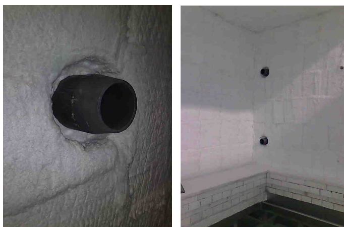
Figura 3.9: Tubo queimador montado em um forno para queima de cerâmica de temperaturas até 1350 °C.
