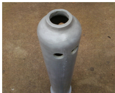
Figura 3.7: a) Tubo queimador padrão 50.000 Kcal; b) visão aproximada do tubo queimador padrão 50.000 Kcal; c) Tubo queimador tipo Ray; d) visão aproximada do tubo queimador tipo Ray.
