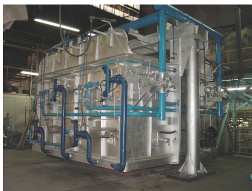
Figura 3.5: Forno Bickley intermitente com capacidade de 16 ton e temperatura máxima de operação de 1750°C.
