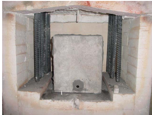
Figura 3.6: Forno intermitente elétrico com câmara refratária de enclausuramento e temperatura máxima de operação de 1450°C.
