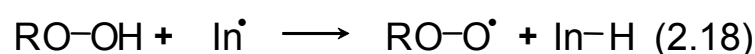
Figura 2.10 – Esquema geral simplificado das principais reações de estabilização de polímero durante a termoxidação, onde RH representa a cadeia polimérica e InH antioxidante [3,4,16,17].
