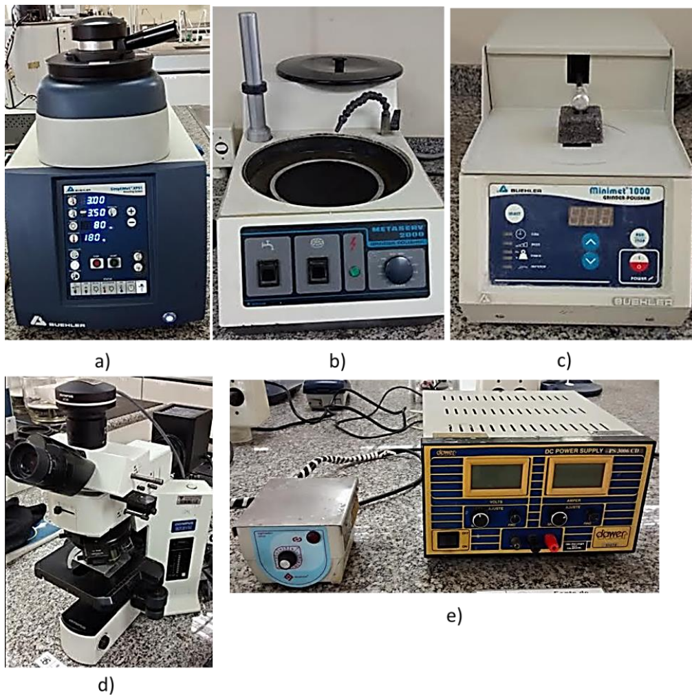
Figura 4.11- Equipamentos utilizados para preparação de amostras e análise microestrutural das ligas 5052: a)Embutidora, b) Politriz, c) Agitador para polimento, d) Microscópio óptico, e) Agitadora magnético e fonte de alimentação CA.
