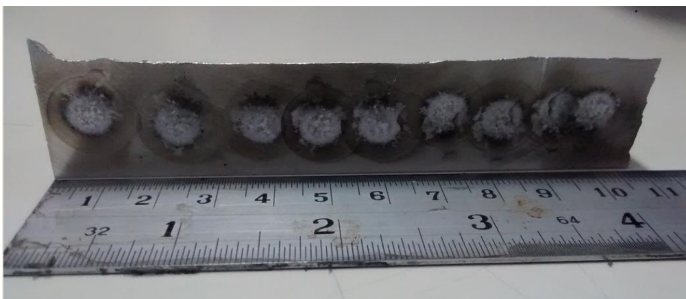
Figura 4.10 - Amostra após análise de composição química em diversas posições a partir da base refrigerada do lingote.
