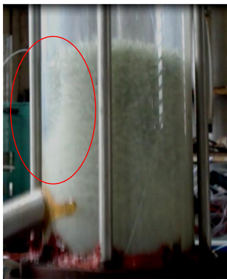
Figura 4.13: Foto do canal preferencial desenvolvido durante o processo de secagem de pasta com vazão de 26mL/min, quando o leito vibrofluidizado foi submetido a agitação com A=0,015\text{m} e f=600\text{RPM} .
