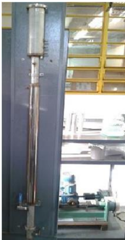
Figura 4.2 – Reator anaeróbio de leito fluidizado termofílico.
