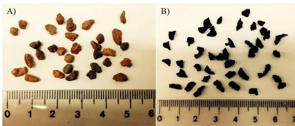
Figura 4.3 – (A) Partículas de argila expandida (cinasita) utilizadas no RA. (B) Partículas de pneu triturado utilizadas no RM1 e RM2.
