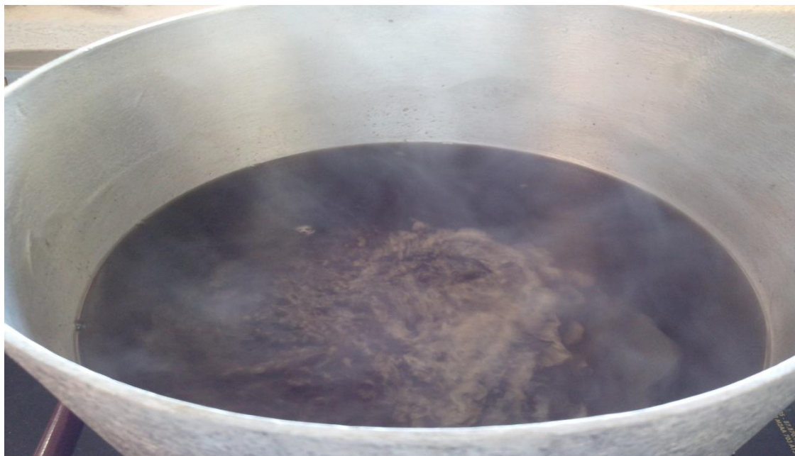
Figura 3 – Caldo em tacho aberto para evaporação
