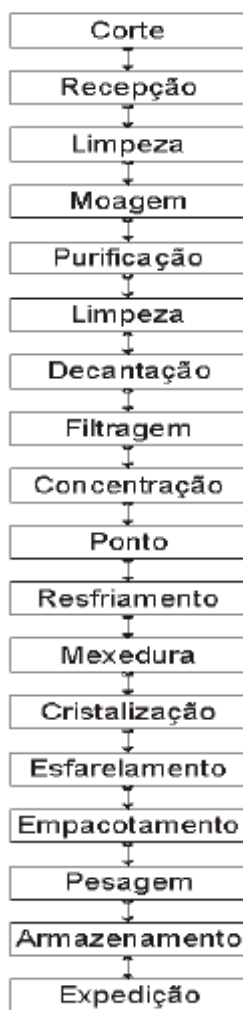
Figura 1 – Fluxograma para a produção do açúcar mascavo
