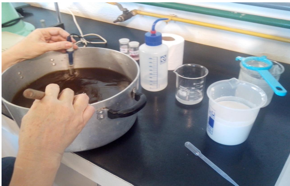
Figura 2 – Correção do pH do caldo de cana
