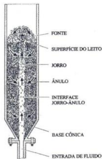
Figura 2.1 - Representação esquemática do leito de jorro convencional com suas regiões características
