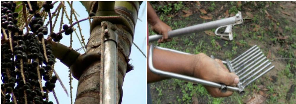
**Figura 12 – Apanhador e debulhador de açai – Sr. Edilson Cavalcante**
