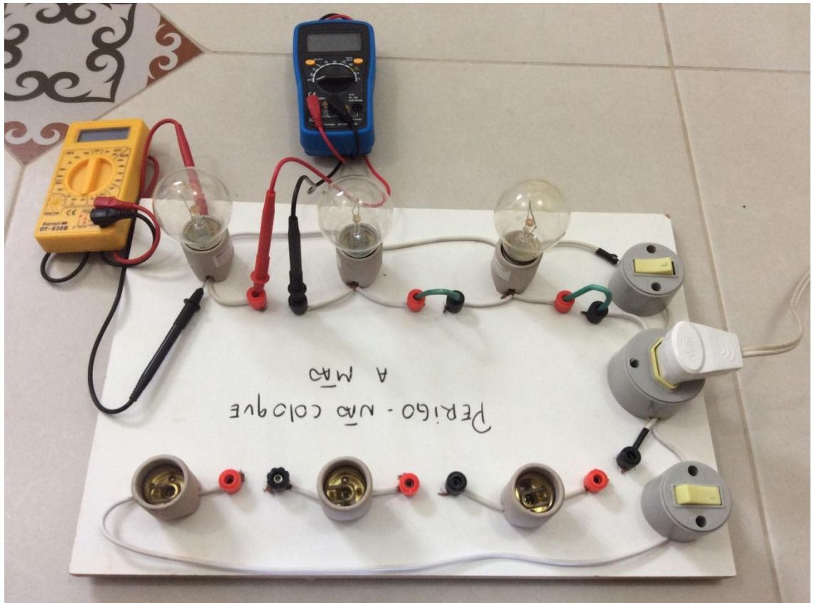
Figura 5.18 - Circuito em série ligado aos aparelhos de medida. (Fonte: do autor)
