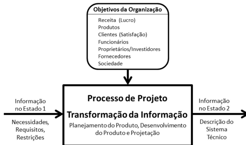
Figura 2-1: Significado do termo projeção Fonte: Hubka e Eder (1995).
