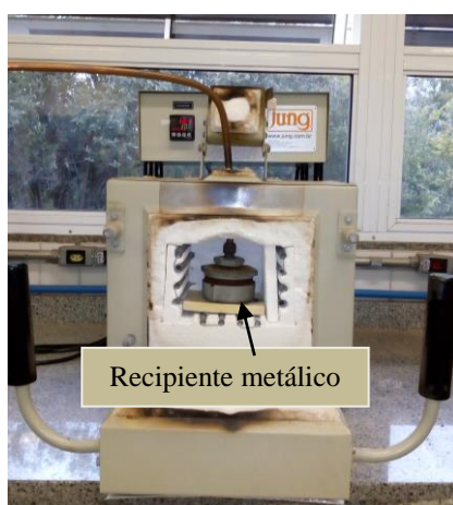
Figura 9. Montagem experimental para produção do carvão vegetal
