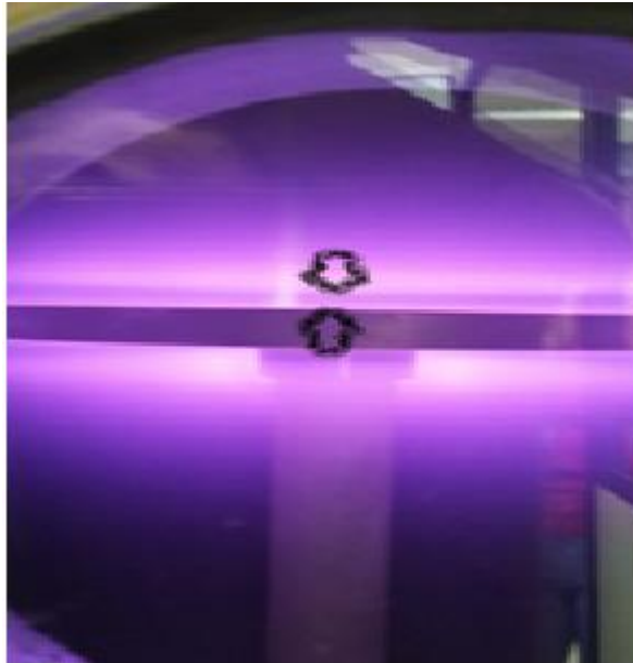
Figura 5.4 Luminescência anômala, com ênfase à bainha catódica a 250 V
