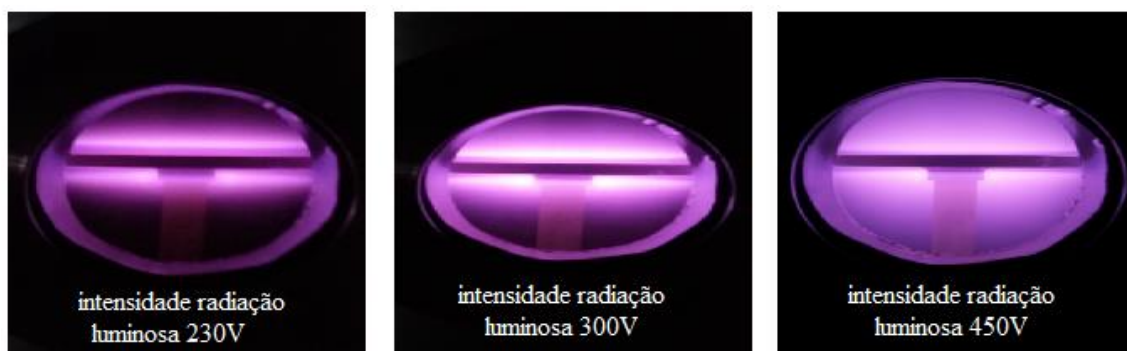
Figura 5.2 Intensidade da radiação luminosa a 230V, 300V e 450V.
