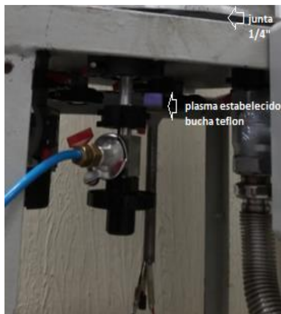
Figura 4.19 Plasma no sistema de vedação.
