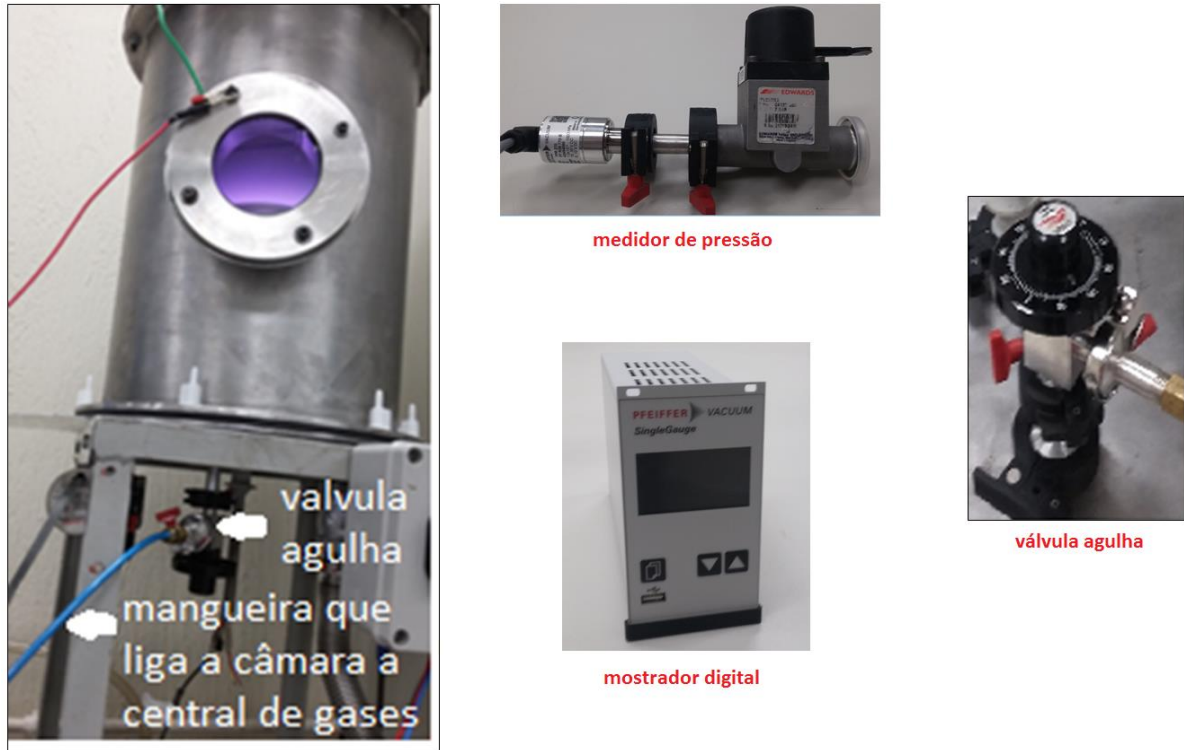
Figura 4.14Mostrador digital da pressão, válvula agulha e medidor de pressão.
