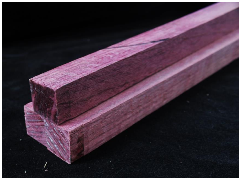
Figura 4.11: Corpos-de-prova de Roxinho utilizados nos experimentos. [Fonte: De autoria própria]
