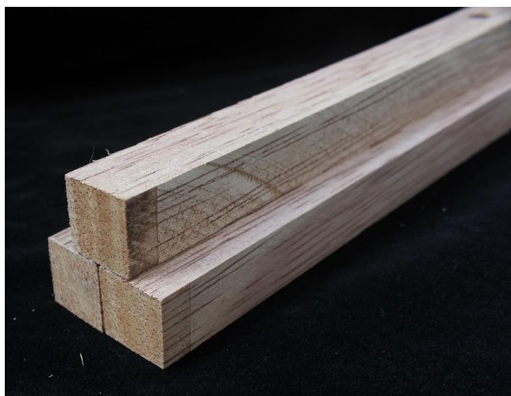
Figura 4.5: Corpos-de-prova de Cedroarana utilizados nos experimentos. [Fonte: De autoria própria]
