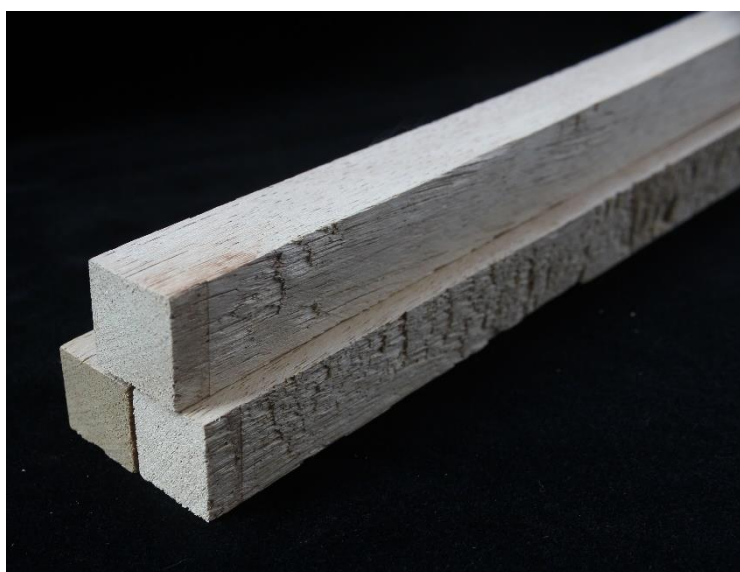
Figura 4.9: Corpos-de-prova de Tatajuba utilizados nos experimentos. [Fonte: De autoria própria]
