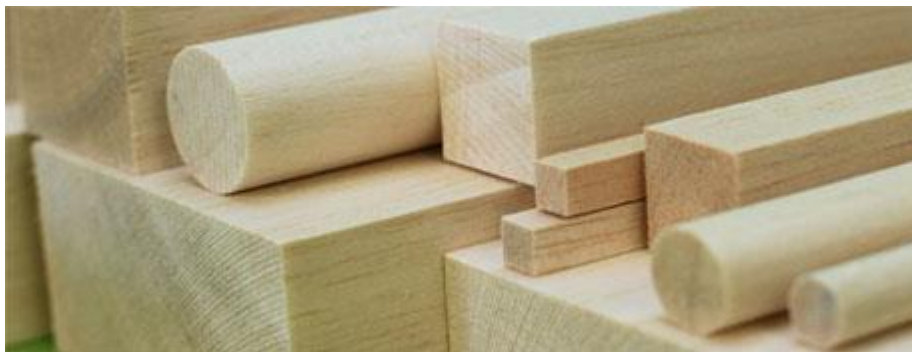
Figura 4.2: Diversos tipos de corpos-de-prova confeccionados com Caixeta. [Fonte: http://nauticurso.com.br/shop/index.php?route=product/category&path=105_86 ]
