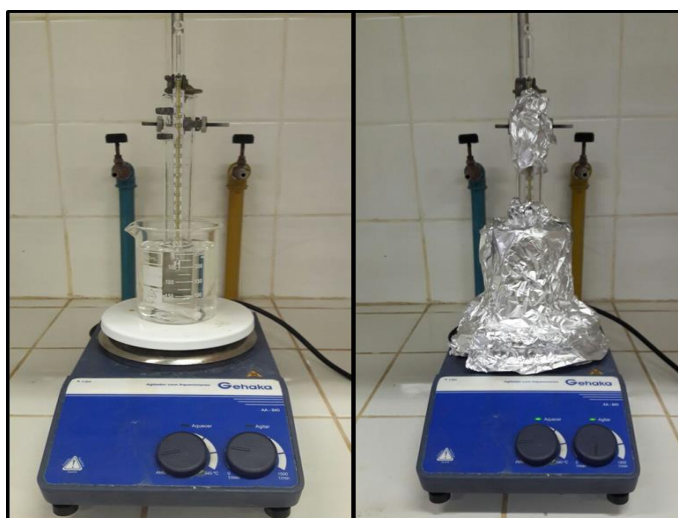
Figura 3.1 Montagem realizada para o Tratamento Hidrotérmico
