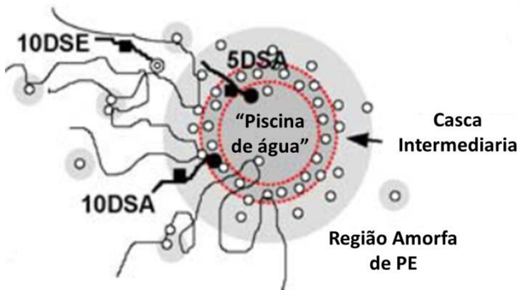
Figura 2.10 Representação esquemática do cluster iônico inchado de água. Apresentam-se os marcadores moleculares (10DSE, 10DSA, 5DSA) do ensaio ESR e suas posições no cluster inchado. [22]
