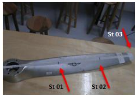
Figura 39: Experiência 01 - Pá da hélice já dividida em 03 estações de igual comprimento.
