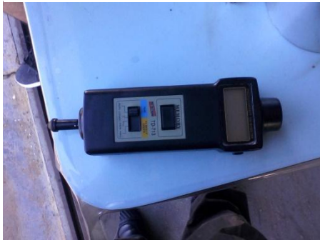
Figura 45: Experiência 1 - Tacômetro óptico utilizado na medição
