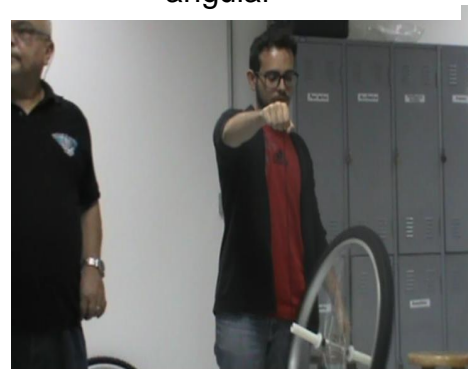
Figura 82: Experiência 05. Demonstração (2) da precessão giroscópica em razão do torque produzido pela decomposição do momento angular
