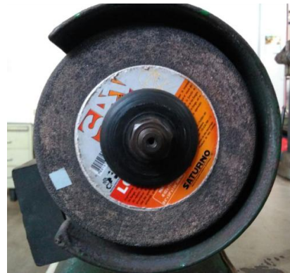
Figura 73: Experiência 4. Detalhe da película reflexiva que será utilizada para a medição da rpm com o tacômetro óptico
