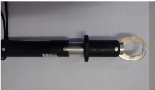
Figura 51 : Balança de mola conhecida também como “balança de peixeiro”
