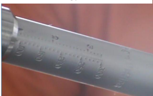
Figura 47 : Experiência 02. Calibrando o torquímetro para a 1 kgf.m
