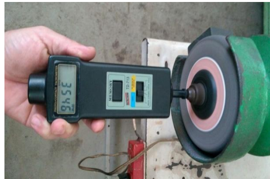
Figura 68: Experiência 04. Detalhe da medida de velocidade angular, 3546 rpm , do rebolo de aceleração da roda de bicicleta, com o tacômetro por contato.
