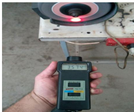
Figura 74: Experiência 4. Medida da velocidade angular ( 3574rpm ) do rebole de aceleração da roda da bicicleta com o tacômetro óptico
