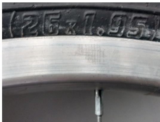
Figura 77: Experiência 4. Diâmetro da roda da bicicleta de 26" impresso em alto relevo no pneu da bicicleta
