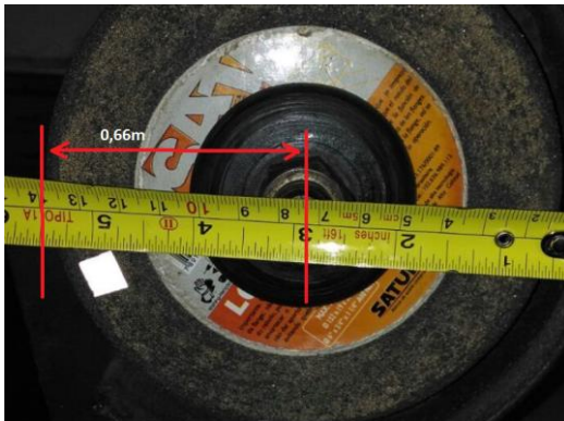
Figura 72: Experiência 4. Medida do raio do rebolo (0,66m) que acelerará a roda da bicicleta
