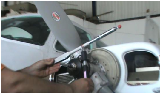
Figura 49 : Experiência 02. Aplicando a força de 5,2\text{kgf} no braço do torquímetro ( St_{01} ) de 0,19\text{m} calculado pelos alunos
