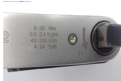
Figura 44 : Faixa de medição disponível no torquímetro de 0,5 a 3,4 Kgfm
