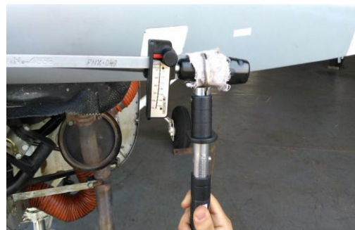
Figura 62: Experiência 3. Medição do torque, em que é possível verificar 3,5 \text{ kgf} \Leftrightarrow 7,6 \text{ kgf (força)} \times 0,46 \text{ m (braço)}
