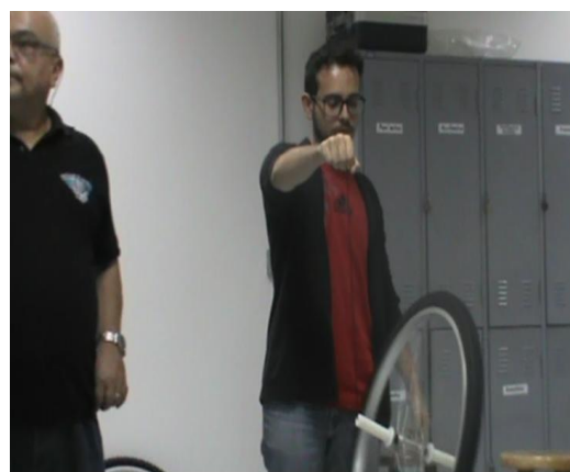
Figura 89: Experiência 5. Demonstração (2) da precessão giroscópica em razão do torque produzido pela decomposição do momento angular.
