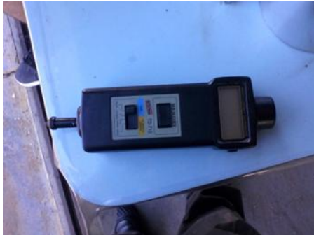
Figura 38: Experiência 01 - Tacômetro óptico utilizado na medição
