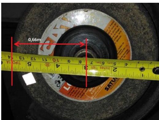
Figura 65: Experiência 04. Medida do raio do reboło, 0,66m, que irá acelerar a roda da bicicleta
