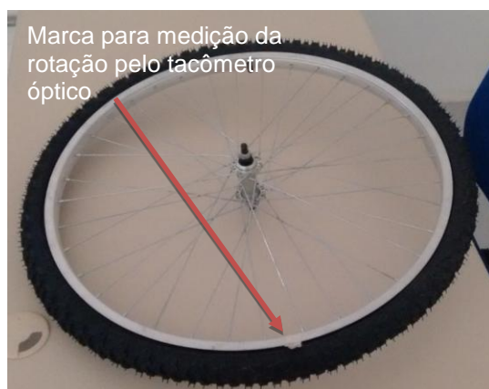
Figura 76: Experiência 4. Roda da bicicleta com detalhe da película reflexiva para medição da rotação pelo tacômetro óptico
