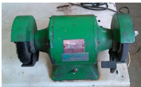
Figura 70: Experiência 4. Motor elétrico AC de 3570RPM utilizado para acelerar a roda da bicicleta
