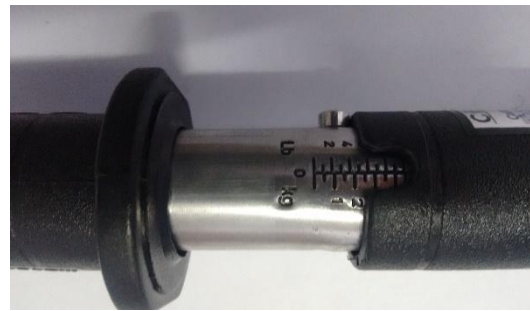
Figura 52: Faixa de medição disponível na balança de peixeiro de 1 à 11kgf
