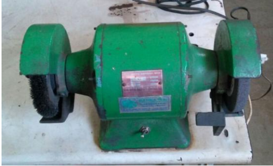
Figura 63 : Experiência 04. Motor elétrico AC de 3570RPM, utilizado para acelerar a roda da bicicleta
