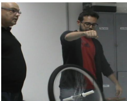
Figura 88: Experiência 5. Demonstração (1) da precessão giroscópica em razão do torque produzido pela decomposição do momento angular.
