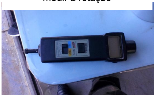
Figura 61 : Experiência 04. Tacômetro óptico utilizado para medir a rotação
