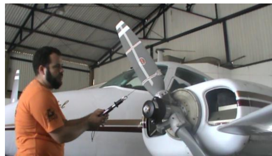
Figura 66: Experiência 3. Outras medições realizadas pelos alunos. Medição do torque necessário para girar a hélice em função do braço St01 e St02
