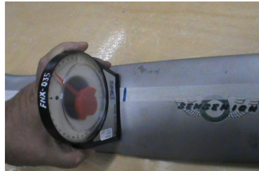
Figura 41: Experiência 01 - Medição do grau de incidência da pá em cada uma das estações usando o protactor
