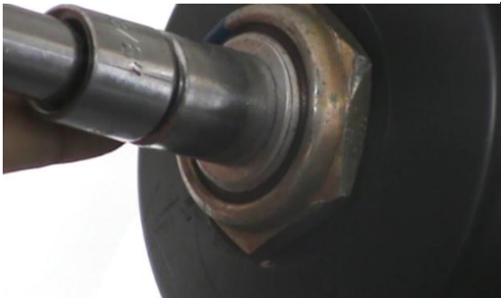
Figura 43 : Experiência 02. Encaixando o soquete de 3/8" do Torquímetro de estalo no parafuso do conjunto da hélice
