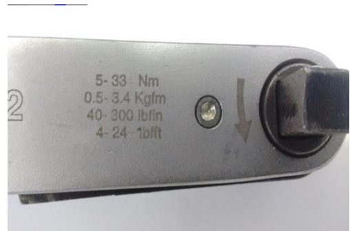
Figura 50: Faixa de medição disponível no torquímetro de 0,5 a 3,4 Kgfm
