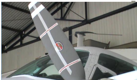
Figura 65: Experiência 3. Outras medições realizadas pelos alunos. Divisão da pá em seções St01 e St02 ou braços.
