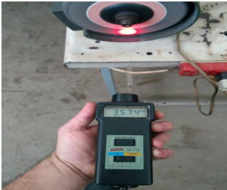
Figura 67 : Experiência 04. Medida da velocidade angular, 3574rpm , do rebolo de aceleração da roda da bicicleta, com o tacômetro óptico
