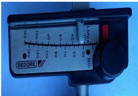
Figura 61: Experiência 3. Detalhe do ajuste de 34,32 \text{ Nm} \Leftrightarrow 3,5 \text{ kgfm}
