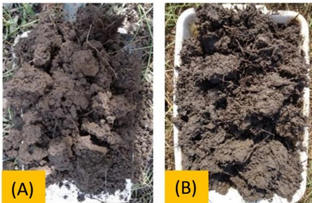
Figura 12. Blocos de solo desestruturados de acordo com o método VESS de Ball e Guimarães em Gleissolo: A) área de proteção permanente (APP); B) pastagem (PAS).
