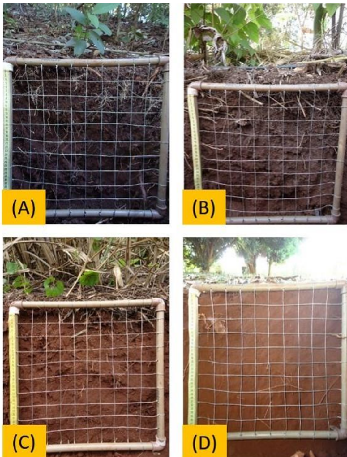
Figura 37. O método do quadro telado (40 x 40 cm), aplicado nas áreas de Latossolo Vermelho: A) mata ciliar (MCI); B) sistema agroflorestal (SAF); C) cana-de-açúcar (CAN); D) pomar (POM).
