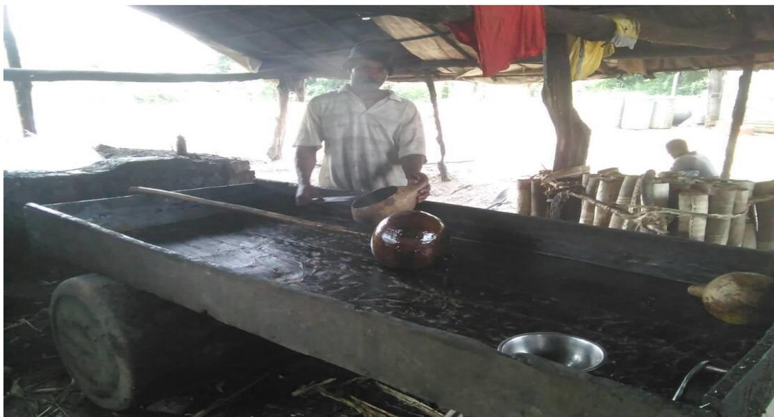
**Figura 7.** Metodo de batimento (Debulha) no engenho depois da evaporação do caldo no Haiti; Fonte: pesquisa do autor.
