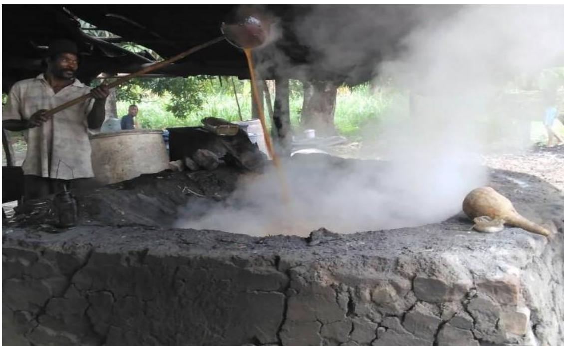
**Figura 6.** Modo de cozimento do caldo para evaporação praticado no Haiti.
