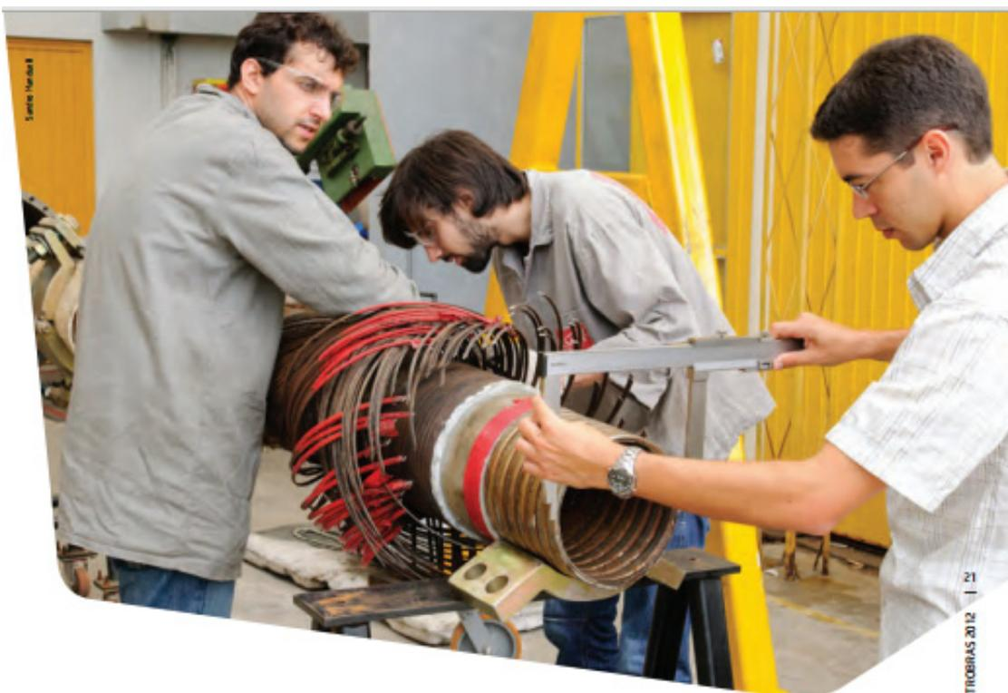
Teste na UFRGS em riser flexível com montagem sem dobramento
