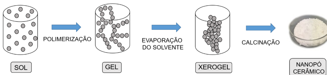
Figura 2.10 - Representação do método de síntese sol-gel para a obtenção de nanopós cerâmicos.
