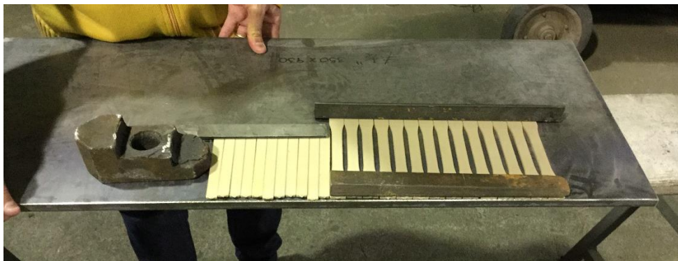
Figura 3.1c Fixação dos corpos de prova para o processo de aspersão plasma.
