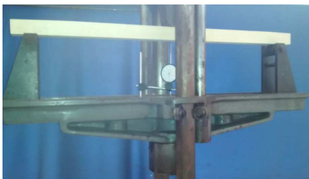
Figura 7. Corpo de prova de madeira Caixeta durante o ensaio de flexão estática.
