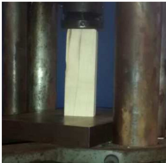
Figura 8. Corpo de prova de madeira Caixeta durante o ensaio de compressão paralela às fibras.
