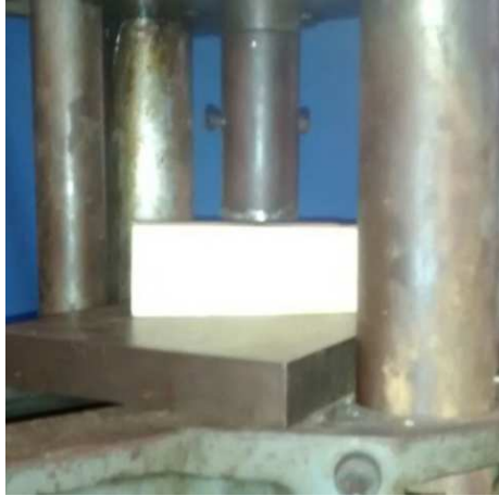
Figura 9. Corpo de prova de madeira Caixeta durante o ensaio de dureza normal às fibras. Fonte: Do autor.
