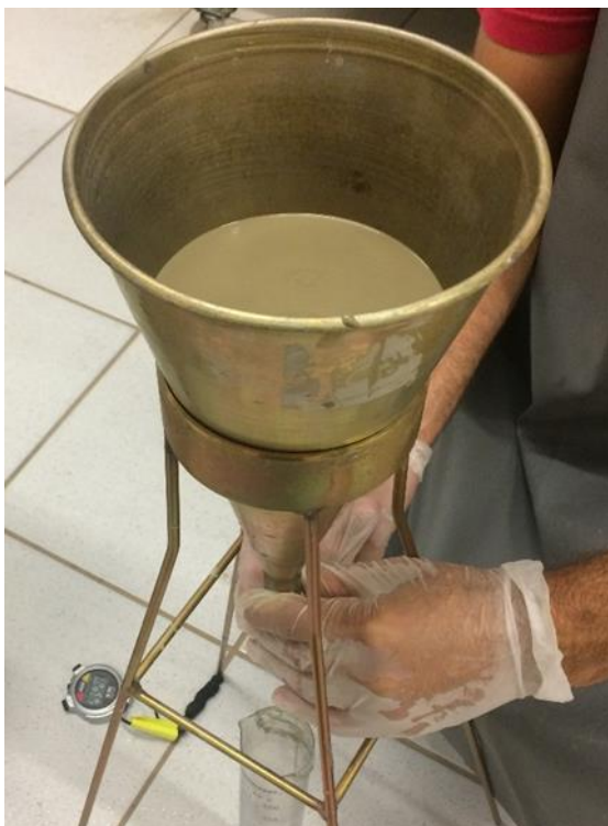
Figura 4.3 - Ensaio do Cone de Marsh.
