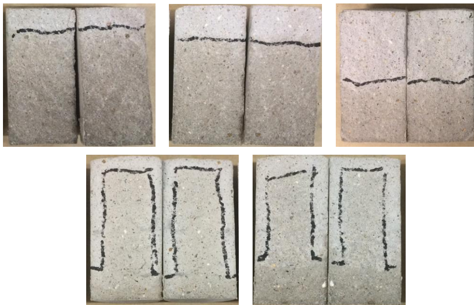
Figura 5.14 - Corpos de prova fraturados após ensaio de absorção de água por capilaridade aos 28 dias: a) A5-REF; b) A5-1-0; c) A5-5-0; d) A5-10-0 e e) A5-1-10.
