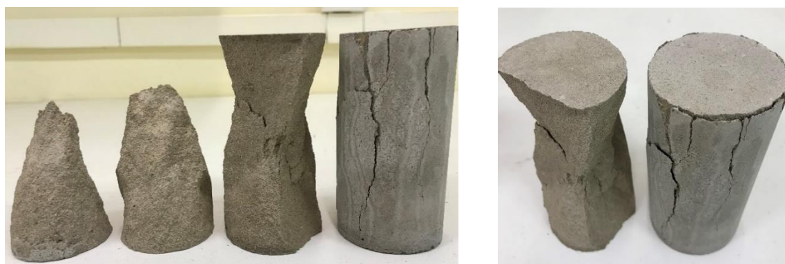
Figura 5.7 - Corpos de prova rompidos no ensaio de compressão axial.
