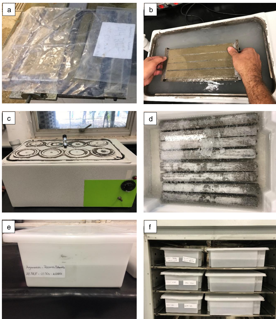
Figura 4.10 - Estágios de cura realizados no ataque externo de sulfatos: a) cura inicial úmida; b) cura inicial térmica - posicionamento dos moldes no banho térmico; c) cura inicial térmica a 85^\circ\text{C} ; d) barras de argamassa posicionadas nos recipientes contendo solução de água saturada com cal; e) cura intermediária; f) cura final em estufa.
