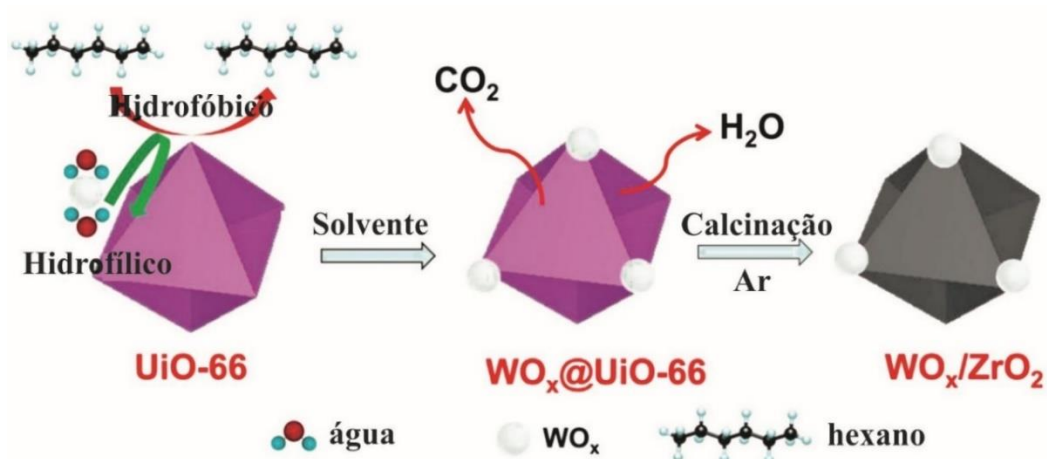
Figura 5.4 - Representação esquemática das etapas de síntese de catalisadores \text{WO}_x/\text{ZrO}_2 preparados a partir da impregnação sobre UiO-66. Tipicamente, uma solução aquosa de metatungstato de amônio é lentamente adicionada a uma suspensão de UiO-66 e mantida sob agitação a 50 °C. Posteriormente a suspensão é filtrada e o pó resultante é seco e por fim calcinado [122].
