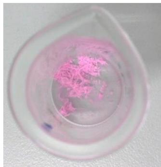
FIGURA 5-27: Aspecto fibra de PLA após ensaio de adsorção com rodamina B
