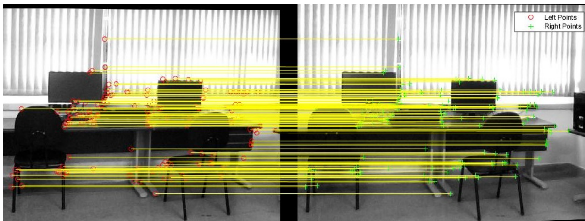
Figura 4.13: Par de imagens estéreo, com os respectivos pontos correspondentes representados, após a retificação planar. Percebe-se que os pontos correspondentes estão alinhados em relação ao eixo y das imagens.
