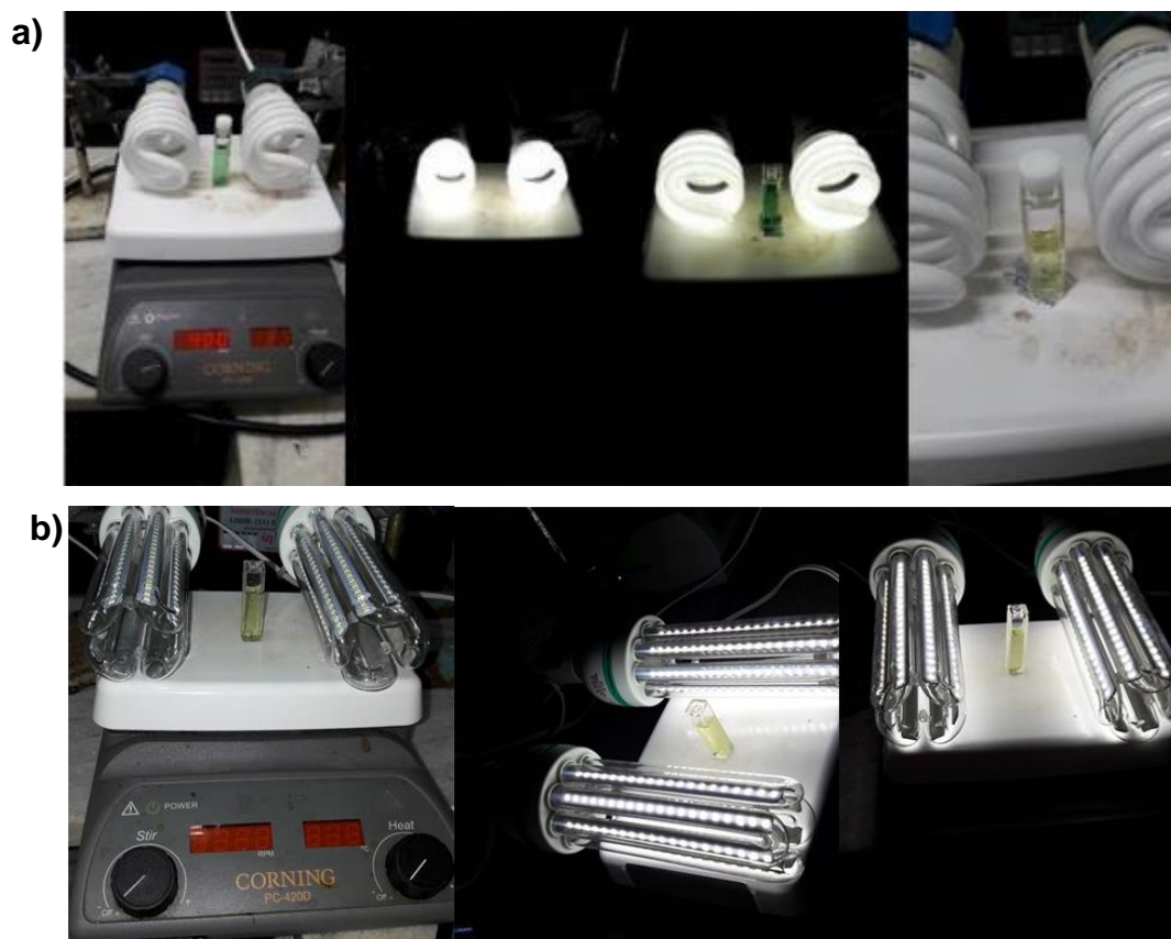
FIGURA 74: a) Fotos do experimento do estudo de fotodegradação da anulenocianina 22 – lâmpada fluorescente (23 W). b) Lâmpada de Led branca (30 W).
