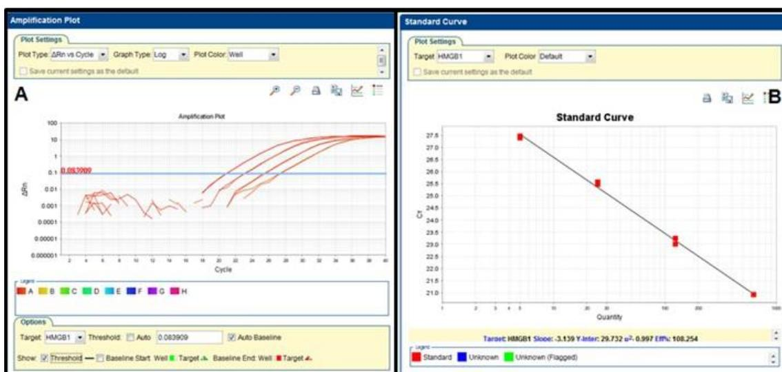
**Figura 12. Teste de Eficiência da HMGB1 300F/100R.** A) As curvas representam as diluições seriadas utilizadas. B) Representação na reta dos pontos obtidos. A partir da análise feita é possível obter a eficiência do *primer*, no caso exemplificado de 108,254%, com um  $R^2$  de 0,997, em um *threshold* de 0,083909.
